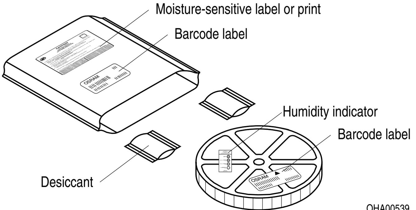
根据JEDEC-STD-33,湿敏产品包装在一个干燥的袋子中，包含干燥剂和湿度卡。
