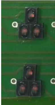
图 5: 一个像素组件的 DISPLIX Oval LED
